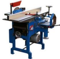
Станок электрический многофункциональный (по дереву)
